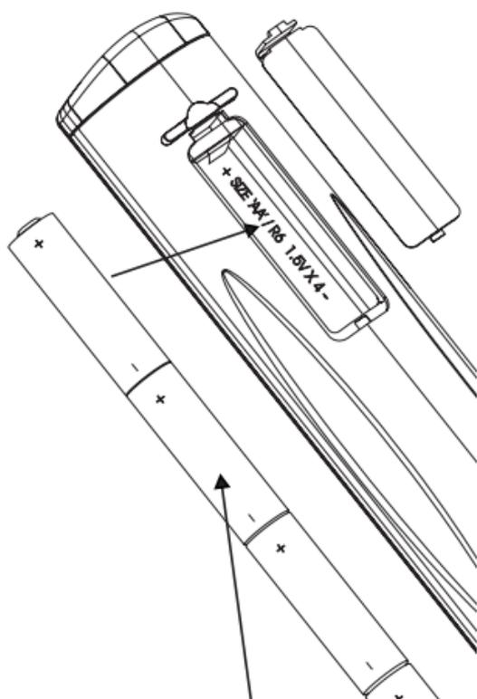
INSTALLARE LE BATTERIE NEL RELATIVO VANO CONTROLLANDO IL RISPETTO DELLA CORRETTA POLARITÀ
