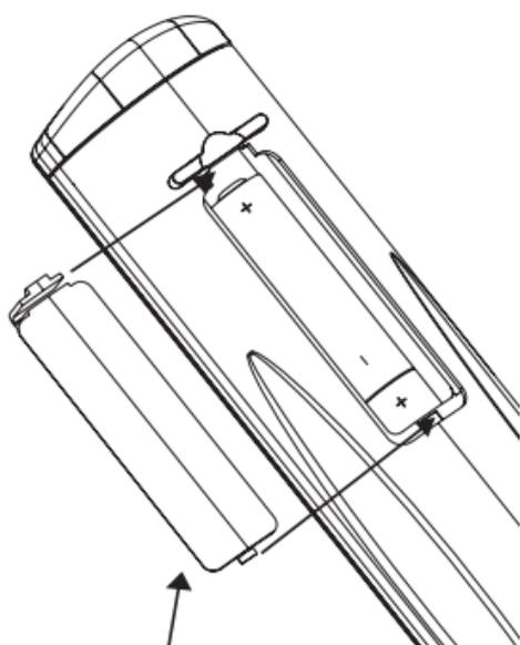
PREMERE LA COPERTURA DEL VANO BATTERIE FINO AD UDIRE UN CLIC CHE NE INDICA LA CORRETTA CHIUSURA
