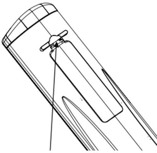
Drücken Sie die Lasche nach innen und heben Sie diese an, um den Deckel des Batteriefachs zu entfernen.
