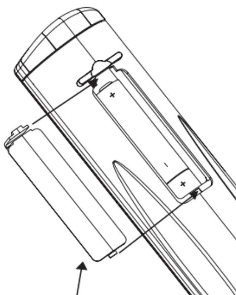
Lassen Sie den Deckel des Batteriefachs hörbar einrasten.
