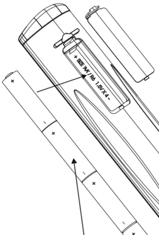
Legen Sie die Batterien in die Öffnung ein. Stellen Sie sicher, dass die Batterien korrekt gepolt sind.
