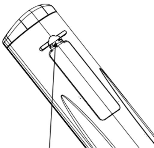
PER RIMUOVERE LA COPERTURA DEL VANO BATTERIE PREMERE E CONTEMPORANEAMENTE SOLLEVARE LA LINGUETTA
